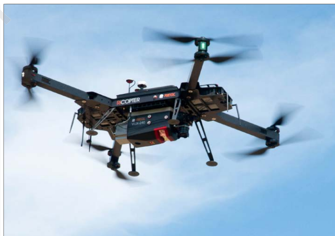
RICOPTER 搭载 RIEGL VUX-240 系统, 集成 APX-20 UAV 和 RGB 正射相机
