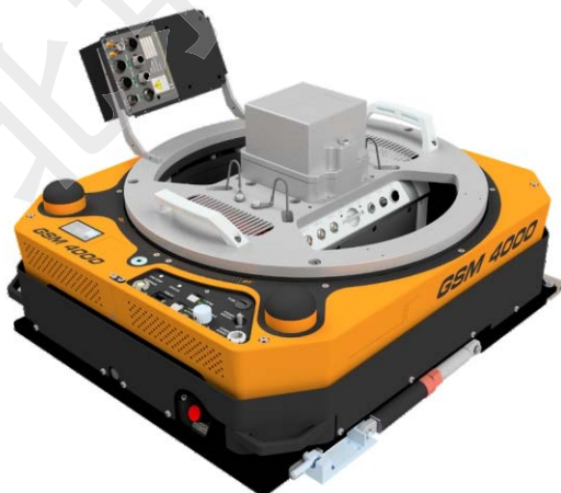
RIEGL VQ-580 II-S 安装于 GSM-4000 陀螺稳定平台
