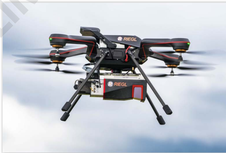
RIEGL VUX-100 25 激光扫描仪 集成 APX-20 UAV IMU/GNSS 模块 搭载于无人机平台
