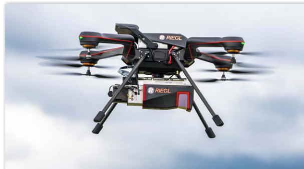
RIEGL VUX-100 25 + APX-20 UAV 搭载在 Acecore Zoe 多旋翼无人机上
